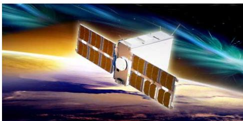
**10 Nov. 2016.** - Le premier satellite connu parmi la charge utile est Xiaoxiang-1, un cubesat de type 6U, d'une masse de 8 kg, d'une puissance de 23 W et d'une espérance de vie de 6 mois.
