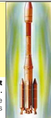
Réussite de l'avant dernier vol Ariane 4 : le lanceur Européen est la version la plus puissante avec 4 boosters d'appoint à liquide.
